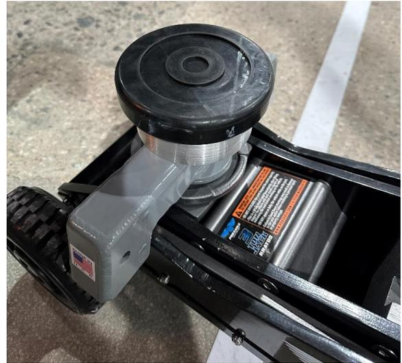
*EDV: Instale el adaptador de soporte de conector EDV en la parte superior de la barra de cabeza*
