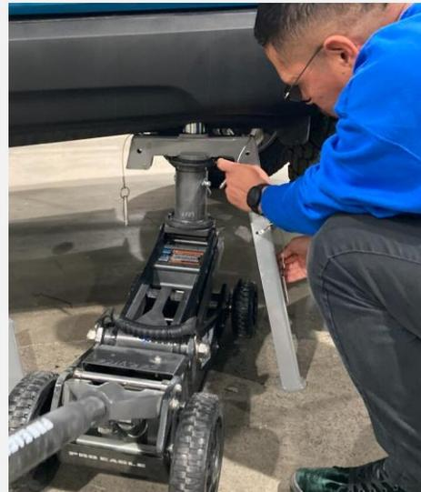
*Instalación de la pata del soporte del gato*
