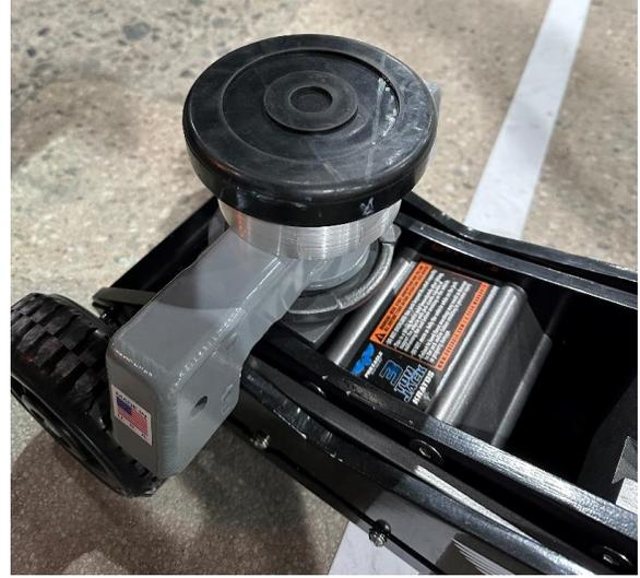
*EDV : Installez l'adaptateur de support de prise EDV sur le dessus de la barre d'en-tête*
